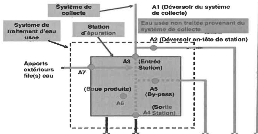
Dans le cas présent, il n'y a pas de point A1, ni A5, ni A7 (aucun dépotage n'étant possible).
